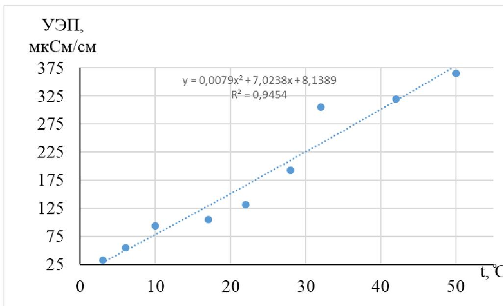
Рис. 2. Зависимость УЭП от температуры неокисленной части
