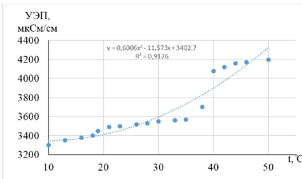
Рис. 3. Зависимость УЭП от температуры окисленной части
