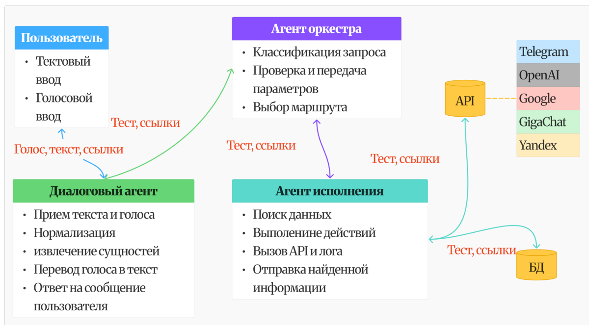
Рис. 1. Общая схема архитектуры интеллектуального ассистента для работы с распределенными источниками данных
