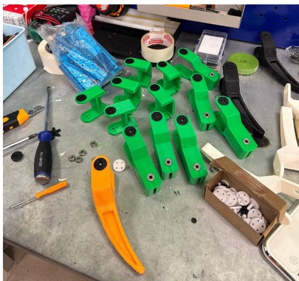
Рис. 1. Напечатанные на 3D-принтере детали ног в процессе сборки
