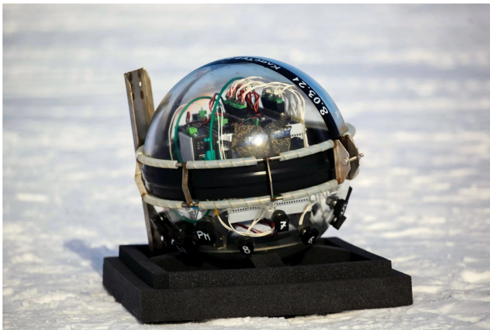
Рис. 1. Нейтринный телескоп Baikal-GVD
