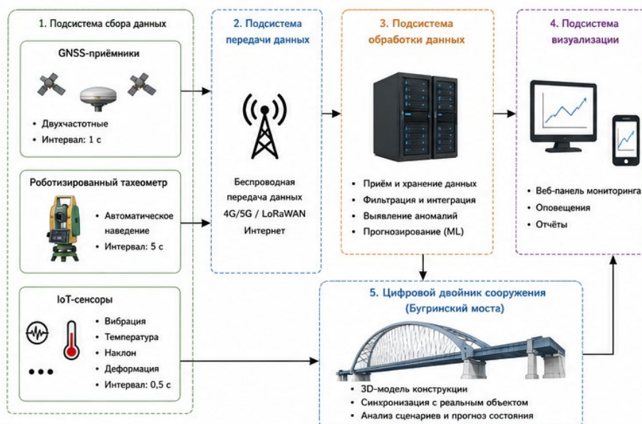
Рис. 1. Архитектура интеллектуальной системы мониторинга деформаций моста.
