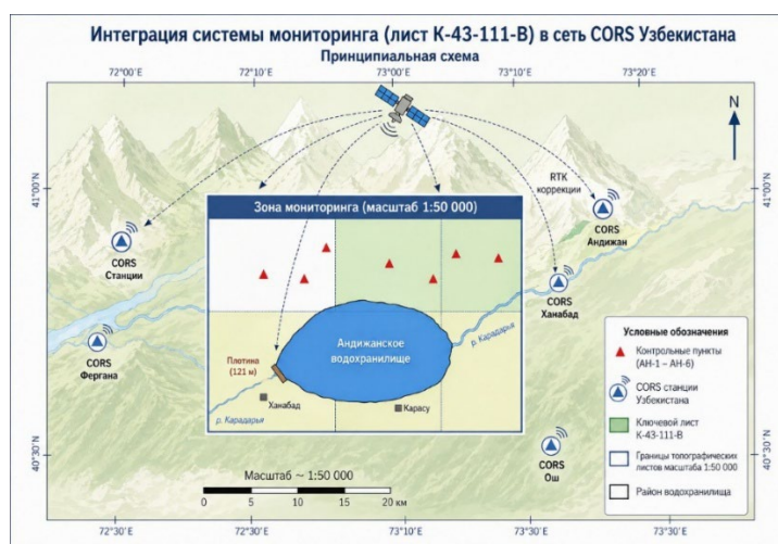
Рис.6. Схема мониторинга водохранилища со станциями CORS
