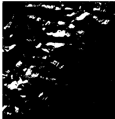
Рис. 3. Слева – RGB композит снимка в гористой местности, справа – результат выделения воды алгоритмом (белым цветом выделяется вода)
