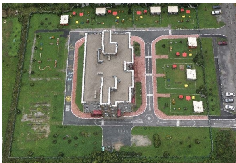
Рис. 1. Фрагмент плотного облака точек земельного участка, полученный с помощью БПЛА
