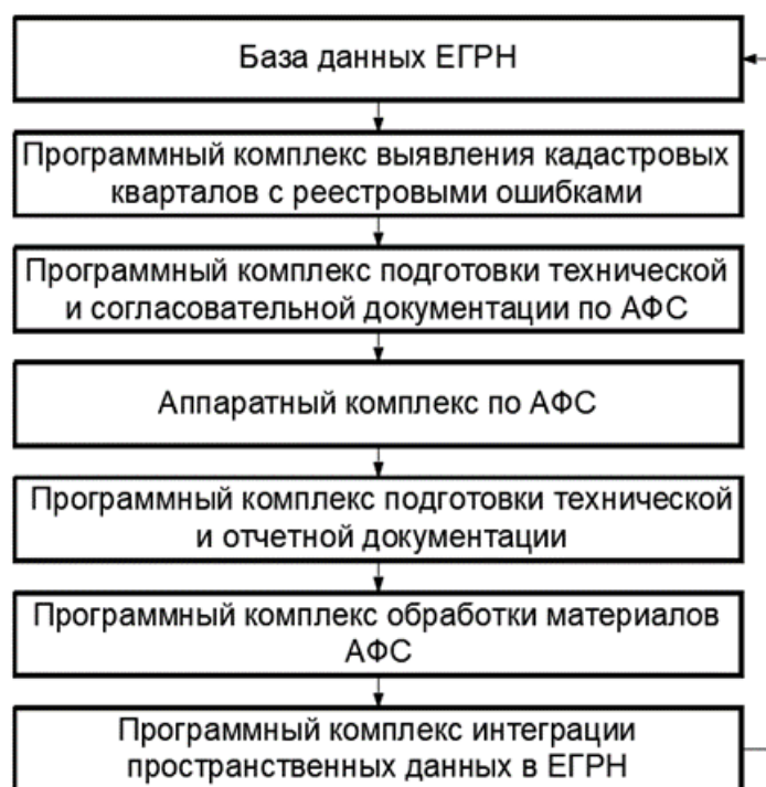
Рис. 1. Блок-схема общей структуры полностью автономной беспилотной системы для целей кадастра недвижимости (АБС-КН)
