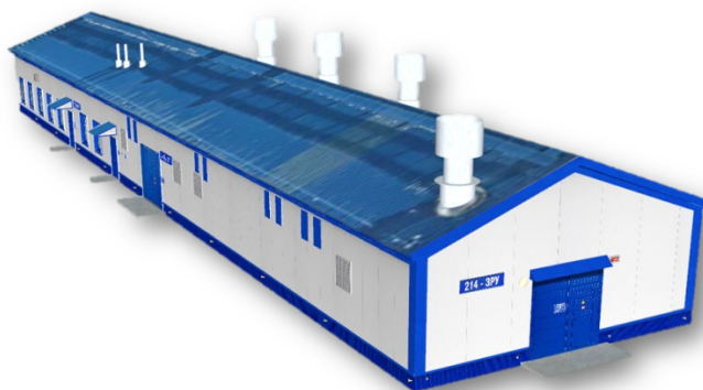
Рис. 5. Трехмерная цифровая модель строения с уровнем детализации LOD 500
