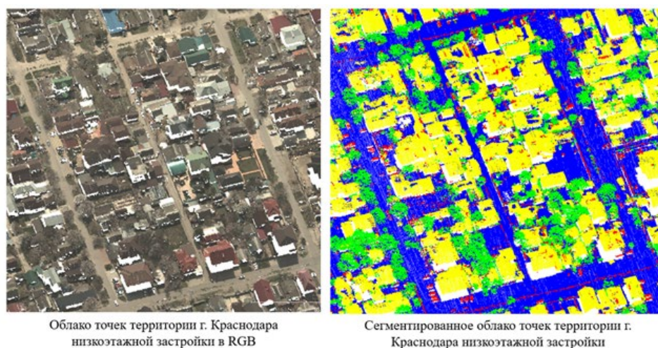
Рис. 2. Результат применения модели для сегментации объектов в облаке точек территории г. Краснодара
