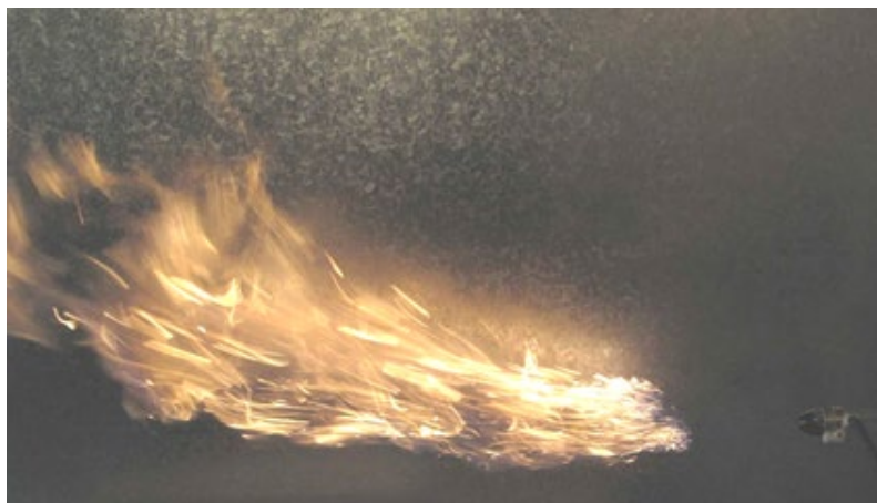
Рис. 2. Факельная установка уничтожения частиц нефтеэмульсии
