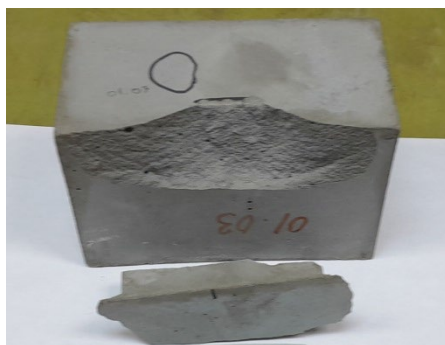
Рис. 2. Фото блока из ПЦС и отколотой падающим клином отдельности
