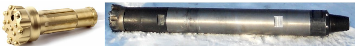
Рис. 2. Импортная буровая коронка DHD350 и опытный образец пневмударника ПВ130
