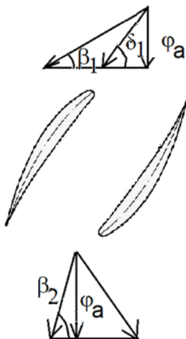
Рис. 5. Плоская решетка, составленная из профилей лопаток РК
