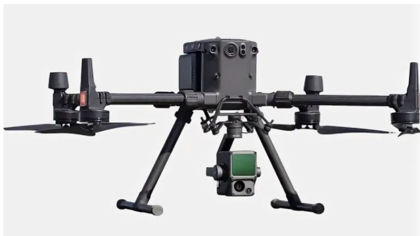
Рис. 2. Беспилотный летательный аппарат DJI Matrice 300 RTK с лидаром Hovermap
