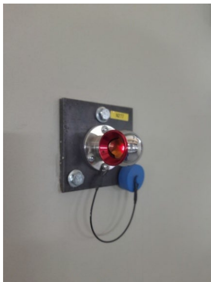
Рис. 6. Геознак сети с уголковым отражателем
