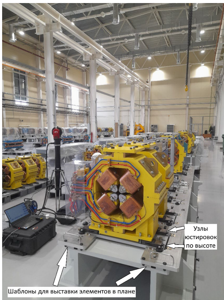
Рис. 3. Вставка элементов с помощью шаблонов
