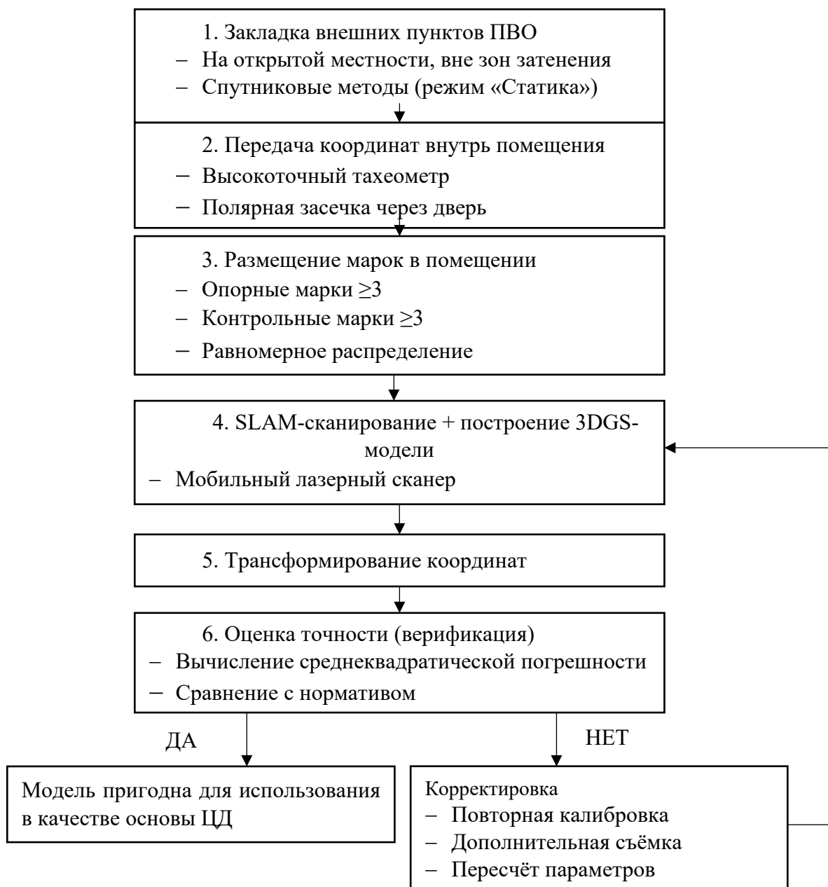
Рис. 2. Методика создания геодезического обеспечения для построения 3DGS-модели
