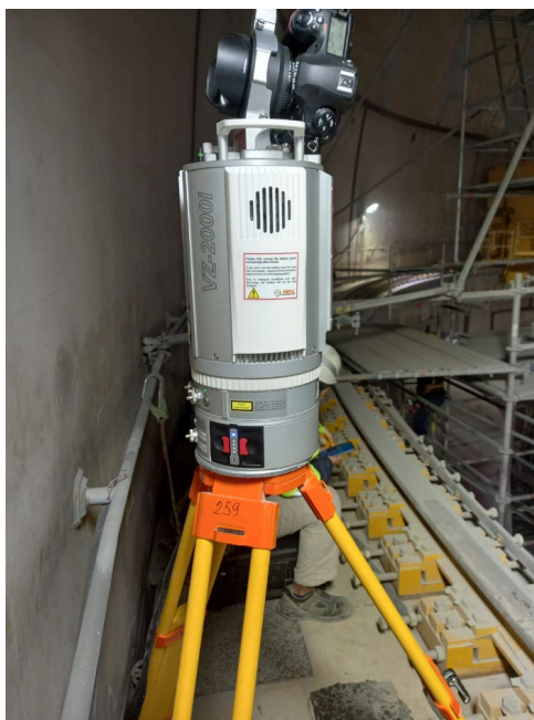
Рис.4. Сканирование ВЗО на монтажном горизонте
