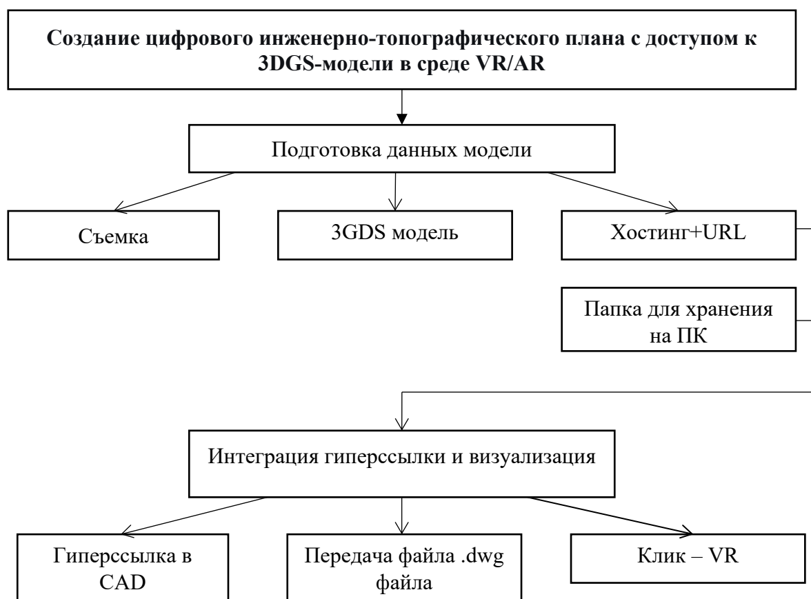
Рис. 2. Блок-схема процесса создания гиперссылки на топографическом плане для доступа к 3DGS-модели в среде VR/AR
