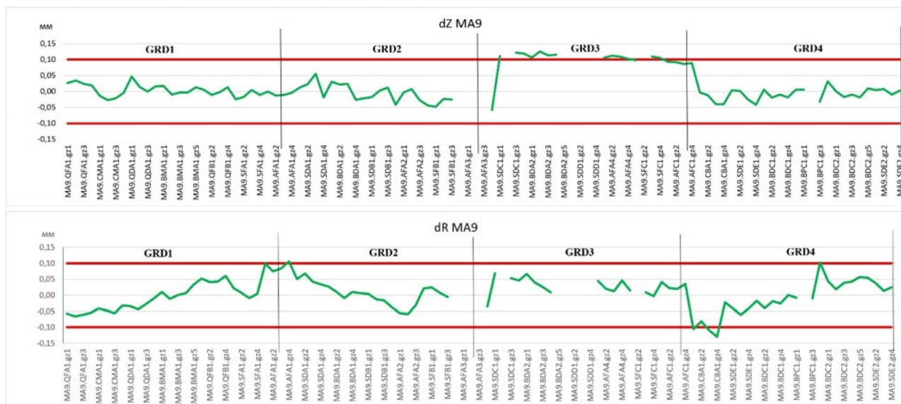
Рис. 11. Графики 3,4 положение гирдеров после сборки вакуумной камеры на примере первых 4 гирдеров 9 арки.
