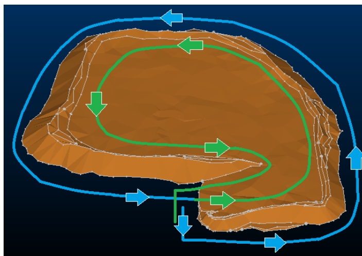
Рис. 2. Типовой маршрут выполнения мобильного лазерного SLAM сканирования для штабеля сыпучих материалов
