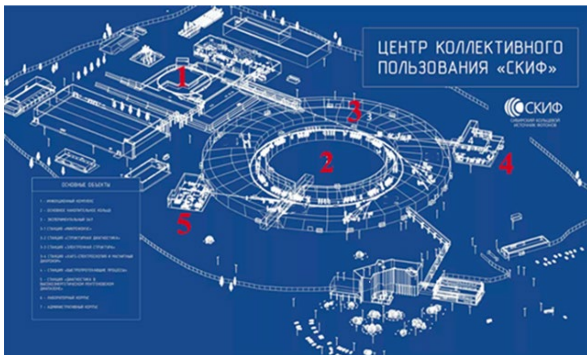
1 – инжектор и транспортный канал Бустер-Накопитель; 2 – здание Накопителя; 3 – зал пользовательских станций; 4,5 – станции 1-3 и 1-5, вынесенные отдельными зданиями.
