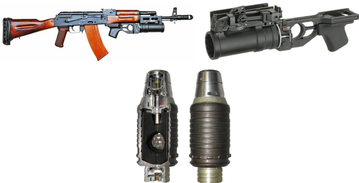
Рис. 3. Гранатомет подствольный ГП-25 (вверху) и граната ВОГ-25П (внизу)
