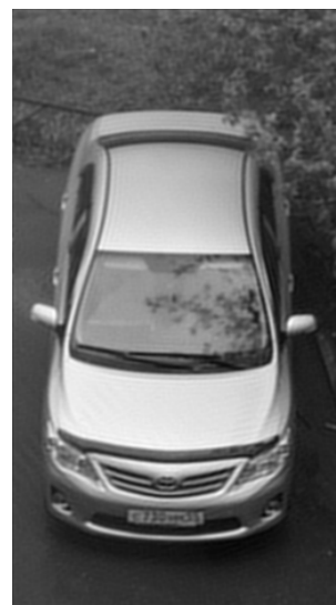
Рис. 6. Восстановление с фазовой коррекцией и учетом шума
