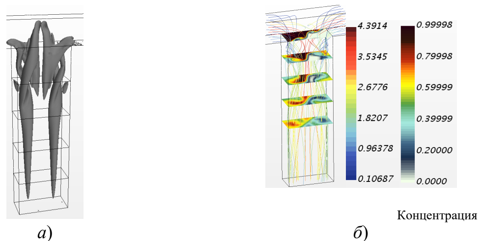
Рис. 1. \lambda_2 -изоповерхность (а) и линии тока с указанием скорости и поля концентраций в поперечных сечениях iD_h , i=0..4 (б) вязкой жидкости в Т-микроканале с наложенными пульсациями при \text{Re} = 120 , f = 200..800 Гц
