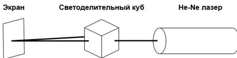
Рис. 2. Схема исследования сведения двух лазерных пучков в точку
