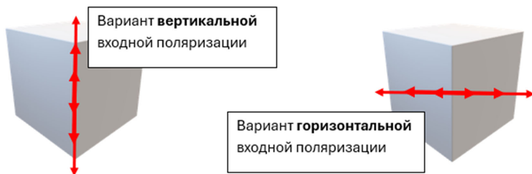
Рис. 6. Положение поляризации лазерного луча на входе в светоделительный куб
