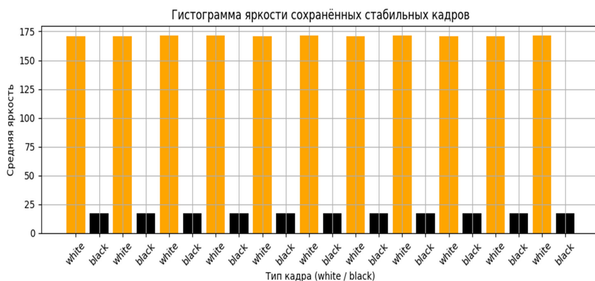
Рис 2. График отображает полученные по одному стабильному черному и белому кадру из каждого цикла проекции, чтобы избежать влияния развертки и переходных состояний проектора
