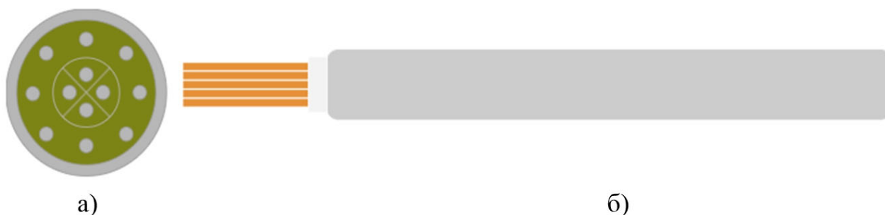
Рис.1. Схема цилиндрического датчика
