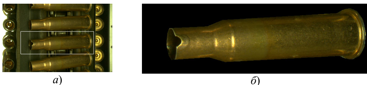
Рис. 4. Выделение гильзы из кадра: а – кадр с наложенной рамкой для одной из гильз, б – изображение гильзы без фона
