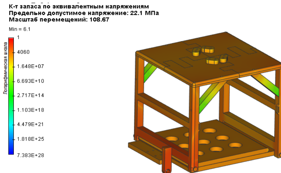
Рис. 2. Анализ коэффициента запаса по эквивалентным напряжениям
