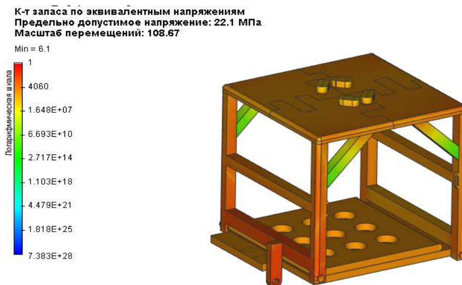
Рис. 2. Анализ коэффициента запаса по эквивалентным напряжениям
