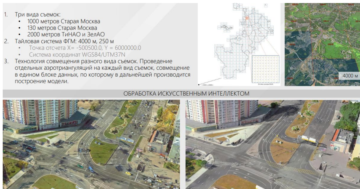
Рис. 2. Фотограмметрическая модель как основа цифрового двойника
