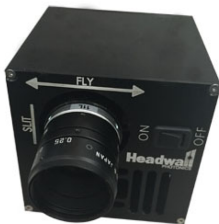
Рис. 2. Гиперспектральная камера Headwall Nano-Hyperspec
