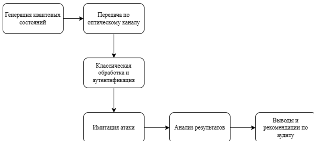
Рис. 2. Блок-схема аудита информационной безопасности при передаче информации по оптическому каналу с КРК
