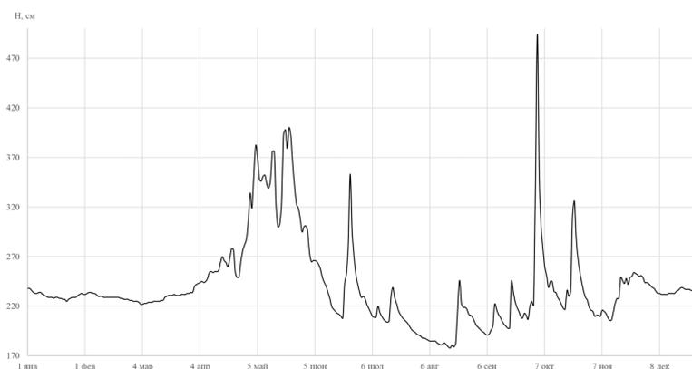
Рис. 2. Гидрограф уровней воды р.Углегорка – с.Краснополье за 2009 г.
