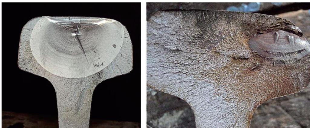
Рис. 1. Заводские дефекты, приведшие к изломам рельсов в пути [6]
