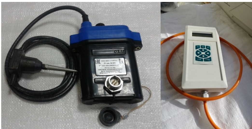
Рис. 5. Автономный одноканальный сейсмический регистратор Р1 а) и пульт оператора б)
