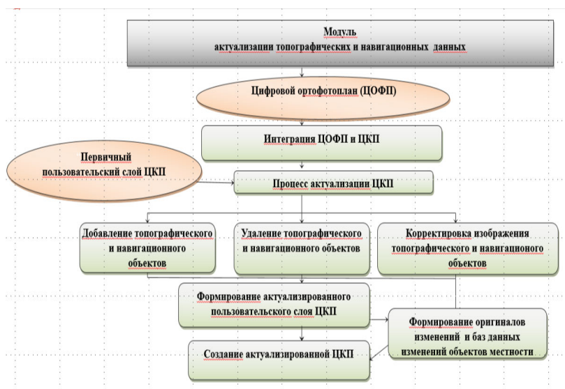
Рис.4. Технологическая схема процесса актуализации цифровой картографической продукции по данным оригинала изменений и базы данных изменений объектов местности
