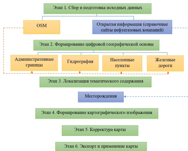
Рис. 2. Технологическая схема создания цифровой карты месторождений Иркутской области
