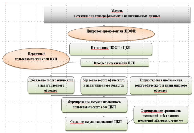
Рис.4. Технологическая схема процесса актуализации цифровой картографической продукции по данным оригинала изменений и базы данных изменений объектов местности
