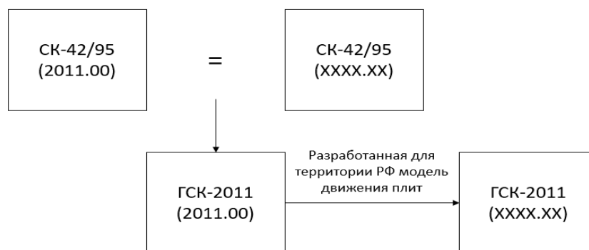
Рис. 2. Схема преобразования координат точки из государственных систем СК-42/СК-95 в государственную геодезическую систему координат ГСК-2011 на эпоху XXXX.XX
