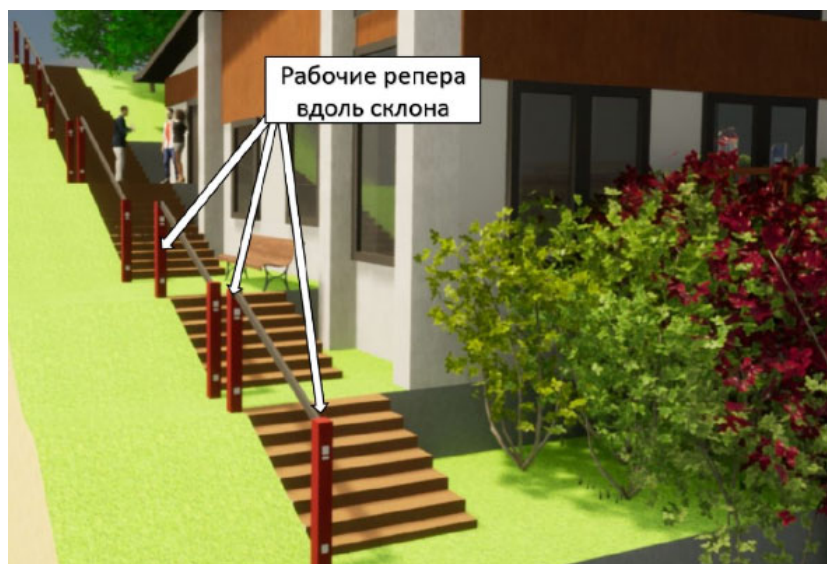
Рис. 8. Наглядная визуализация расположения реперов
