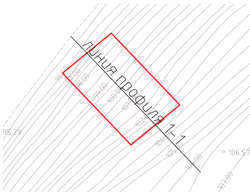
Рис. 2. Проект посадки здания на рельеф
