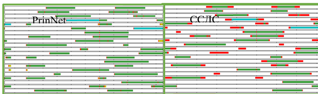
Рис. 2. Результат отслеживания спутников и решения уравнений фазовых псевдодальностей в CSRS-PPP. Цвет: зеленый – фиксированное решение, красный – захват спутника (решения нет), желтый – плавающее решение, голубой – неоднозначность в данных
