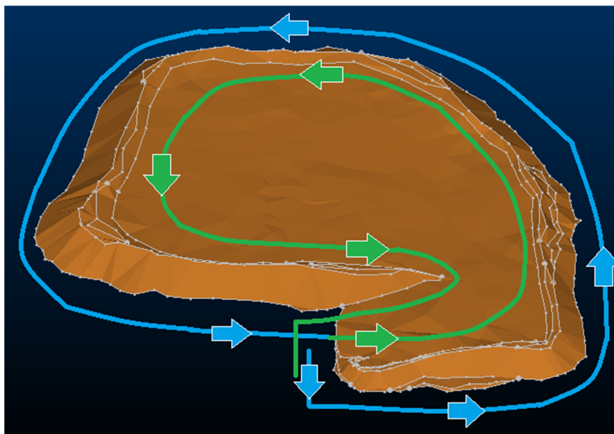
Рис. 4. Типовой маршрут лазерного сканирования на примере съемки рудного штабеля
