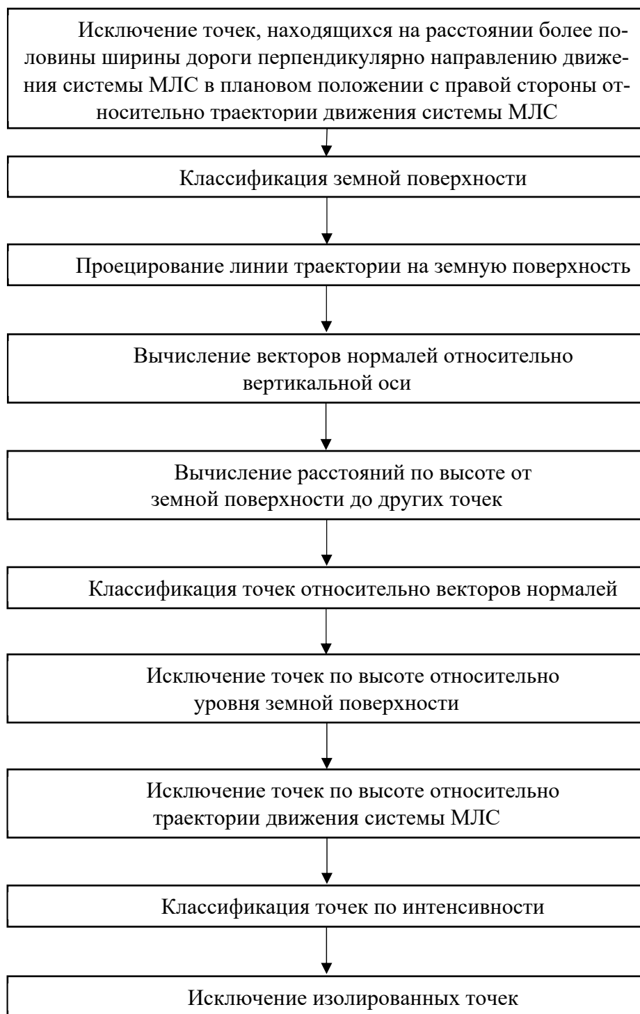
Рис. 1. Методика распознавания дорожной разметки по данным МЛС
