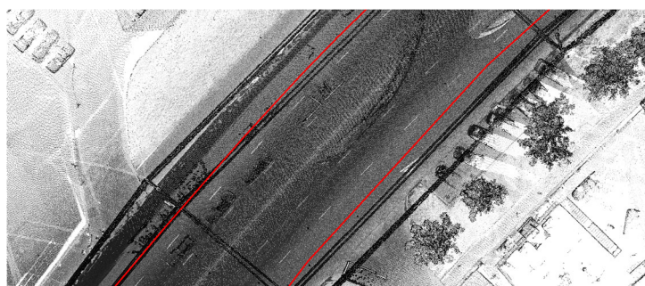
Рис. 2. Исходный массив ТЛО в режиме отображения по интенсивности
