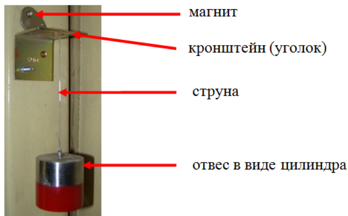
Рис. 1 – Конструкция отвеса цилиндрической формы
