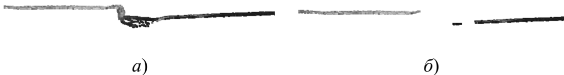
Рис. 9. Вертикальное сечение бордюра: а) до классификации; б) после классификации
