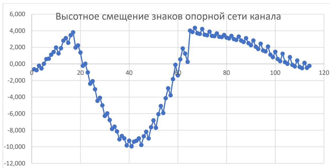
Рисунок 3 – График вертикальных смещений геодезических знаков сети транспортного канала за период сентябрь 2024 – февраль 2025 (Ось абсцисс – номера наблюдаемых точек, Ось ординат – разница отметок)
