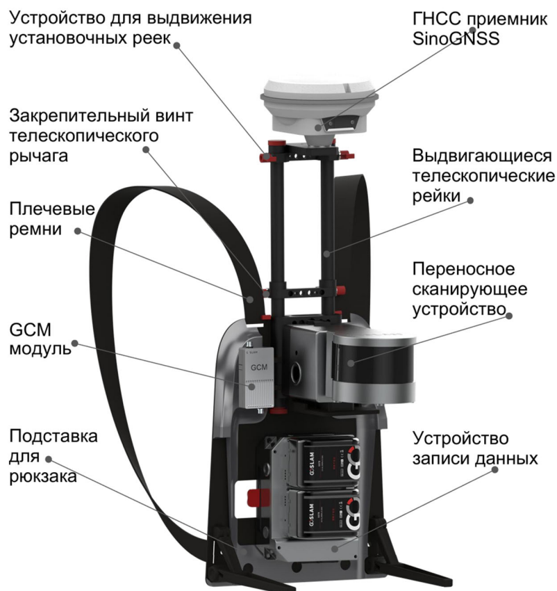
Рис. 2. Мобильный лазерный сканер Goslam RS300 в сборе на рюкзаке
