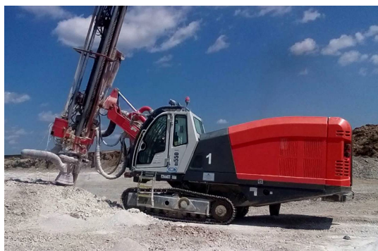
Рис. 2. Буровая установка Sandvik DI550 для бурения с погружным пневмоударником
