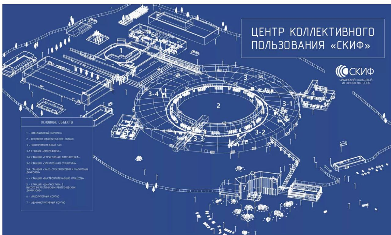
Рисунок 1 – основные составные части источника синхротронного излучения СКИФ, где 1 – инжектор и транспортный канал Бустер-Накопитель; 2 – здание Накопителя; 3 – зал пользовательских станций (станции №3-1...); 4,5 – станции, вынесенные отдельными зданиями.
