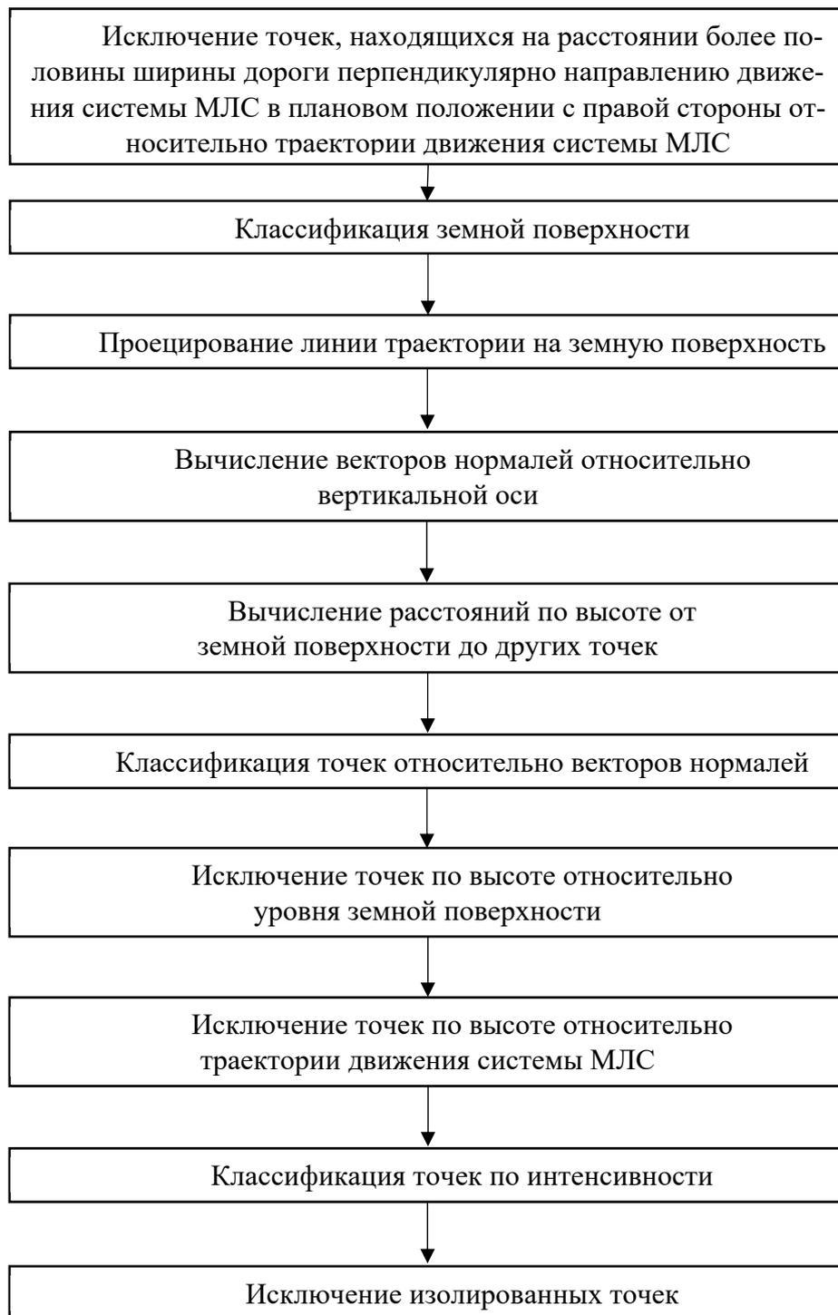
Рис. 1. Методика распознавания дорожной разметки по данным МЛС
