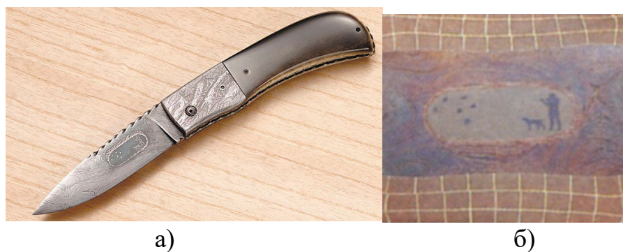
Рис. 9 «Мечта охотника»: а) готовый нож; б) пакет мозаики для ножа после уменьшения ковкой.
