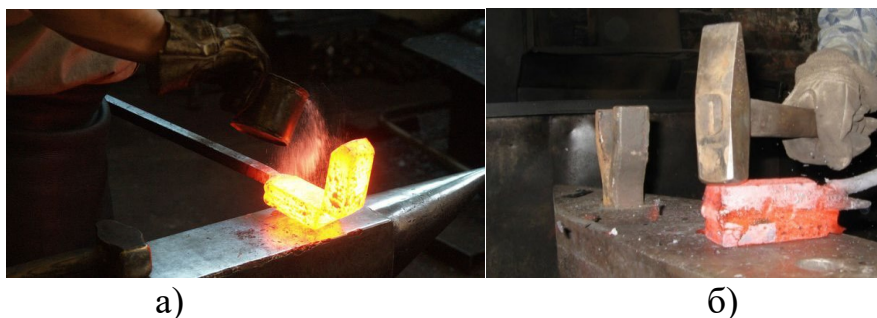
Рис. 3. Нарращивание слоев без охлаждения:
