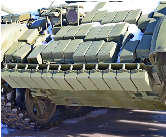
Рис. 1. Танк, оснащенный навесной ДЗ «Контакт» (слева), и устройство блока ДЗ «Контакт» (справа)
