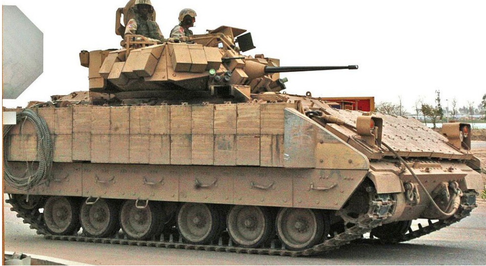
Рис. 6. БМП Bradley с динамической защитой
