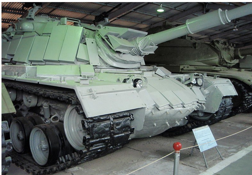
Рис. 4. Танк М48А3 с динамической защитой
