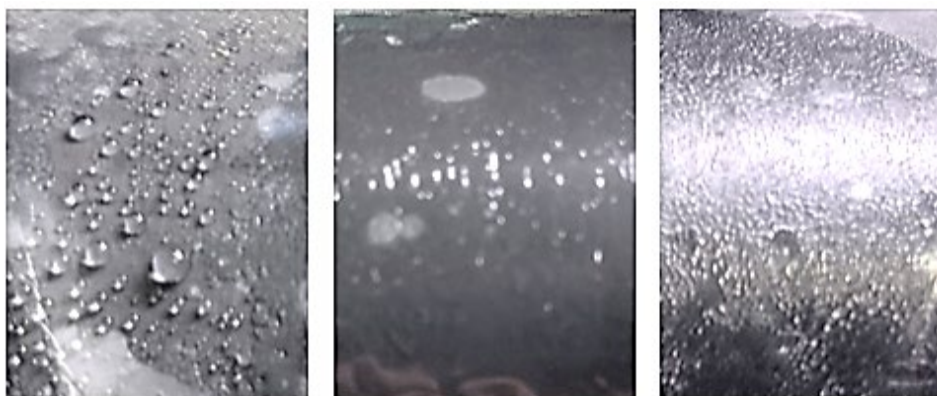
Рис. 6. Образование наледи с эмиссией водного аэрозоля для нанотравы, микростолбов с бороздками и гладкой пленки (слева направо)
