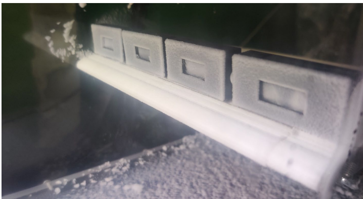
Рис 3. Обледеневшие образцы в климатической трубе
