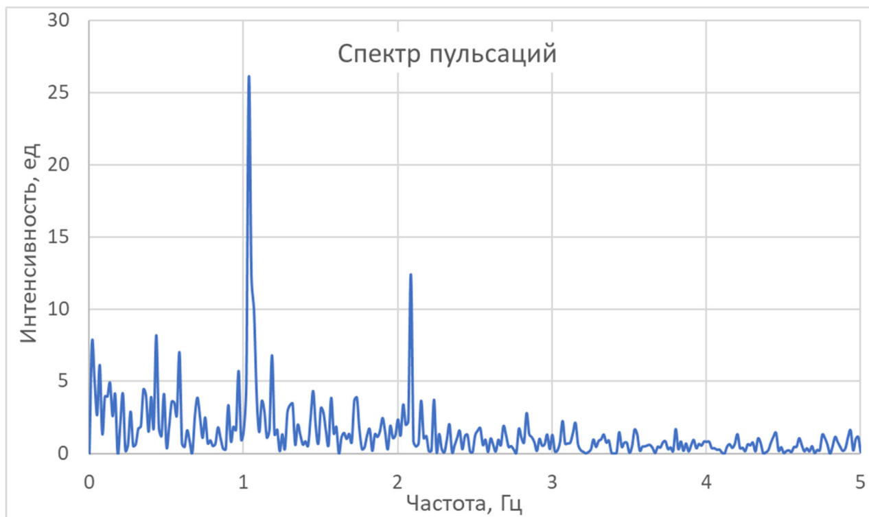
Рис. 4. Спектр пульсаций при 30 оборотах в минуту
