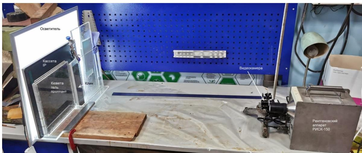
Рис. 1. Постановка эксперимента в оптическом и рентгеновском диапазонах излучения
